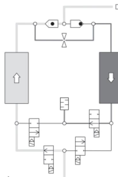
In questa figura, la rigenerazione avviene nel serbatoio a profilo cavo di destra
